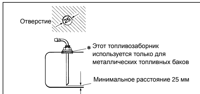
Рис.11: Топливозаборник Webasto из бака
